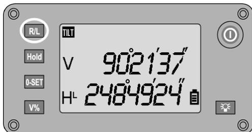
Pulsando la **tecla R/L**, la dirección para la medición del ángulo horizontal puede cambiarse entre derecha (sentido horario) e izquierda (sentido antihorario).
